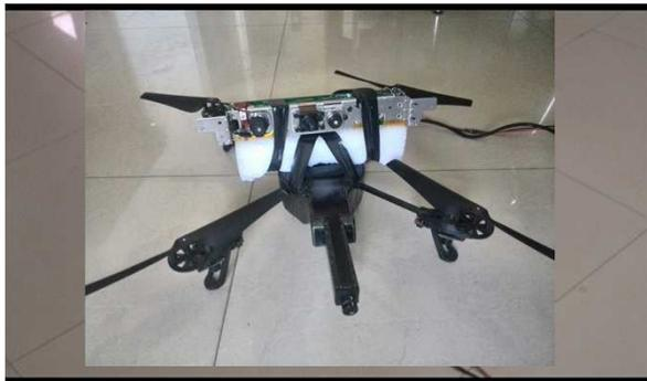
Kinect与四旋翼搭载的成果图
